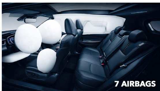
Frontaux, protège-genoux conducteur, latéraux avant et rideaux
